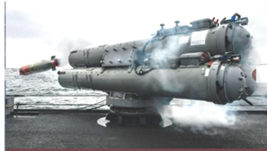
図1 水平型魚雷発射機
